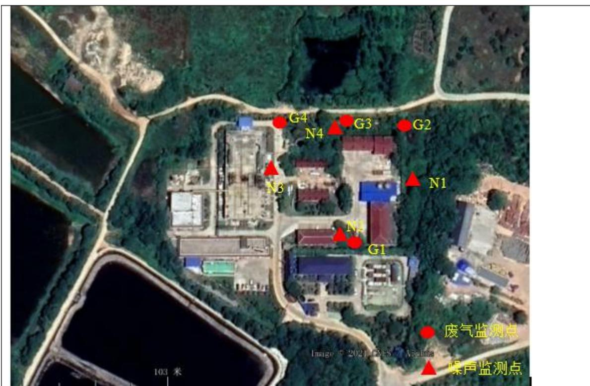
图 3-4 项目噪声和无组织废气监测布点图
