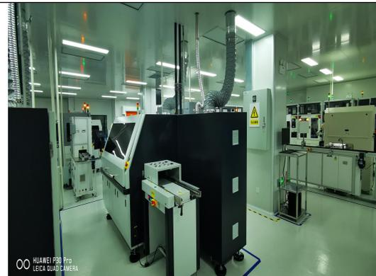
真空回流焊废气密闭收集
