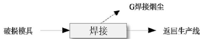
图 2-4 原环评模具维修工艺流程与产污节点图
