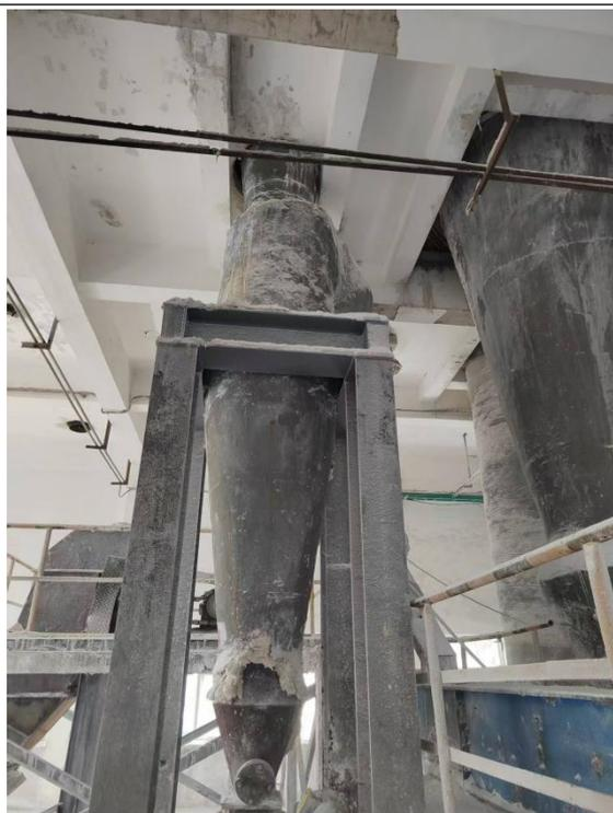
重灰工序旋风除尘器
